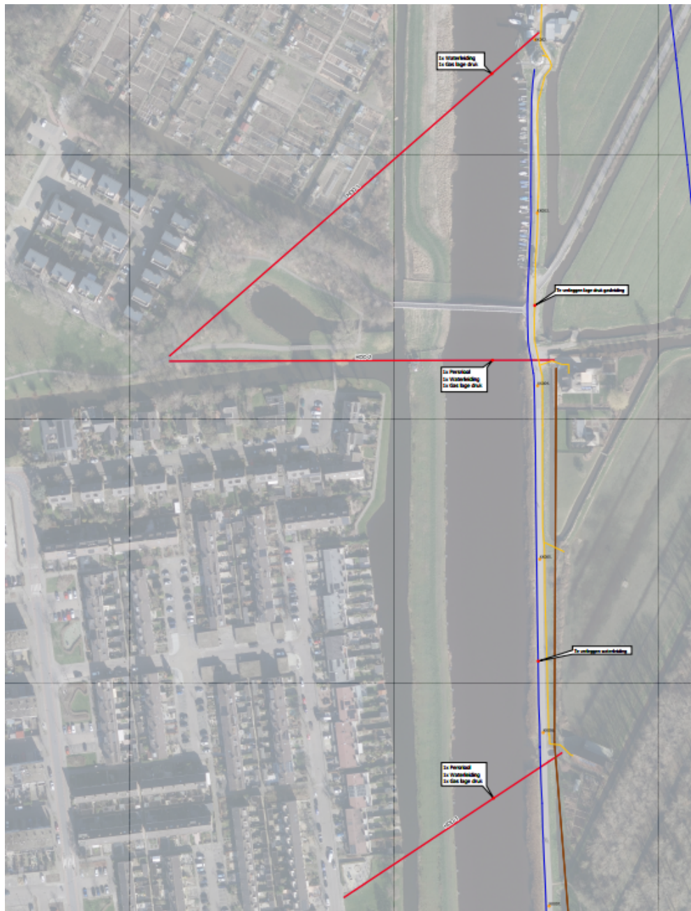
Figuur 4.3 Uitsnede uit bijlage 3 van het conceptverleggingsplan leidingen Kade Kortland (d.d. 15 sept 2023). De rode lijnen geven de te realiseren HDD boringen weer.
